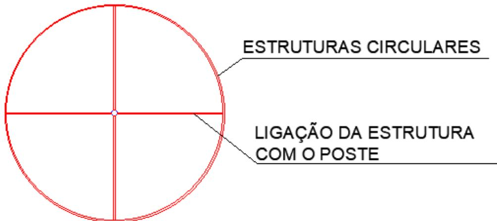
Para 1 poste de iluminação a estrutura a ser instalada é a seguinte:
